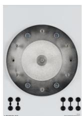
Pour le montage de machines électriques dans le cadre d'expérimentation et de démonstration (301 300) avec un rail profilé (301 311) supplémentaire ou dans un cadre de montage (par ex. 726 04).
