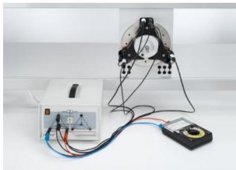
Dans l'expérience P3.5.4.4, on étudie le comportement de moteurs synchrone et asynchrone lors d'un changement du sens de rotation.
