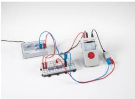
Dans l'expérience P3.6.1.4, le générateur de fonctions produit des signaux rectangulaires périodiques qui représentent l'enclenchement et la coupure d'un courant continu.
