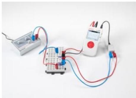
Dans l'expérience P3.6.1.5, on applique une tension alternative d'amplitude  $U_0$  et de fréquence  $f$  à un condensateur.
