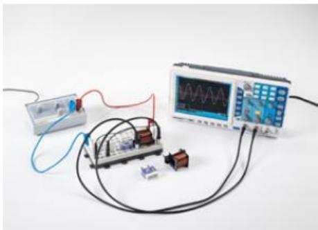
Dans l'expérience P3.6.2.2, on applique une tension alternative d'amplitude  $U_0$  et de fréquence  $f$  à une bobine. La tension  $U_L(t)$  et le courant  $I_L(t)$  sont représentés simultanément sur l'oscilloscope.
