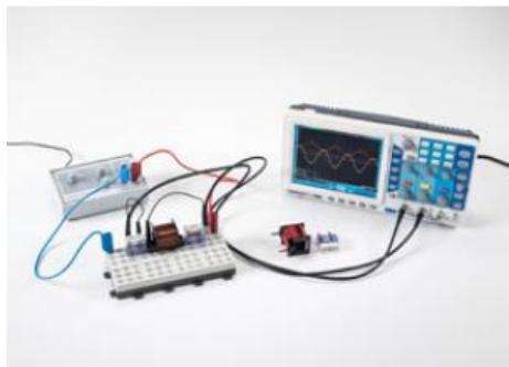
Dans l'expérience P3.6.3.3, on étudie le circuit oscillant en tant que montage série et parallèle de capacité et inductance.
