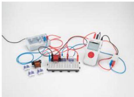
Dans l'expérience P3.6.3.6, on étudie le circuit oscillant en tant que montage série et parallèle de capacité et inductance.
