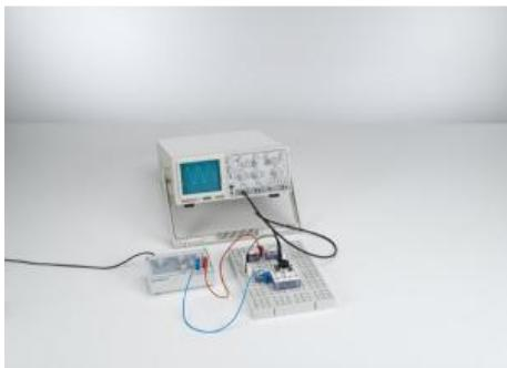
Dans l'expérience P3.6.4.1, on étudie le principe d'un pont de mesure de Wien pour la mesure d'une résistance capacitive Z1.
