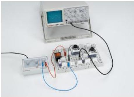
Dans l'expérience P3.6.4.2 , on monte un pont de mesure de Maxwell pour déterminer une résistance inductive Z1 .
