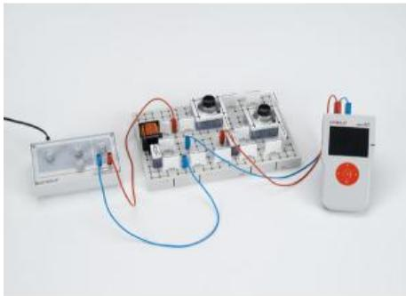
Dans l'expérience P3.6.4.4 , on monte un pont de mesure de Maxwell pour déterminer une résistance inductive Z1
