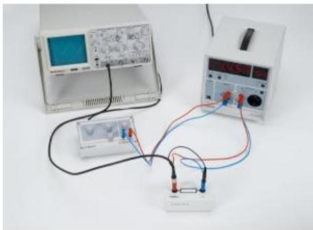
Dans l'expérience P3.6.6.4, on détermine expérimentalement les facteurs de crête, à savoir les quotients des amplitudes  $U_0$  et des valeurs efficaces  $U_{eff}$  pour différents signaux de tension alternative produits avec un générateur de fonctions.
