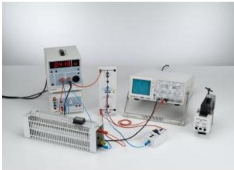
Dans l'expérience P3.6.6.5, on mesure le courant  $I_{eff}$  dans une charge quelconque et la puissance efficace  $PW$  pour une tension alternative fixe  $U_{eff}$ .
