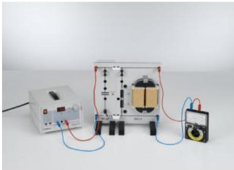
L'expérience P3.7.1.1 consiste à étudier les oscillations électromagnétiques libres. L'atténuation est si faible que plusieurs périodes d'oscillation peuvent être suivies, et leur durée peut se mesurer. On observe les écarts entre période d'oscillation mesurée et période d'oscillation calculée à partir de la formule de Thomson
