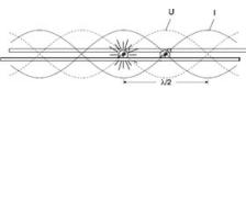
Avec une fréquence de service de 433,92 MHz (bande UHF des 70 cm/ bande ISM (Industrial, Scientific, Medical) pour l'étude expérimentale des conditions de propagation d'ondes électromagnétiques (radiodiffusion) dans l'espace libre et dans des milieux diélectriques, par ex. dans l'eau et sur des systèmes à fils de Lecher.
