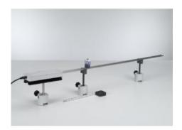
P3.7.3.1 Détermination des maxima de courant et de tension sur une ligne de Lécher
