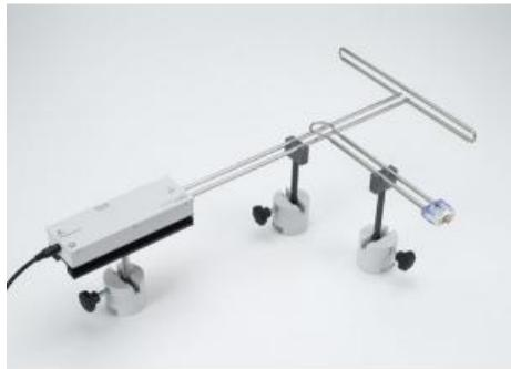
Dans l'expérience P3.7.3.2, on fixe un dipôle émetteur (dipôle trombone  $\frac{\lambda}{2}$ ) à l'extrémité de la ligne de Lecher.
