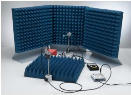
Dans l'expérience P3.7.6.1, on enregistre la directivité d'une antenne hélicoïdale.
