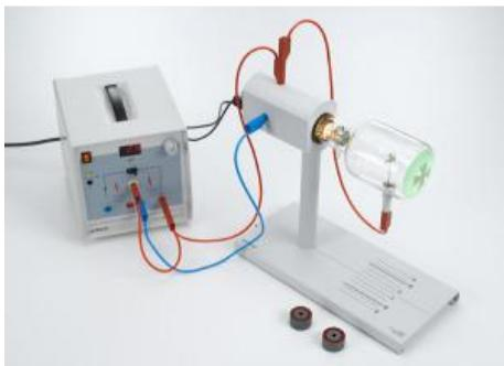
**P3.8.3.1 Démonstration de la propagation rectiligne des électrons dans un espace sans champ**
