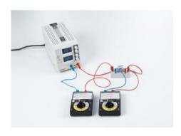
Dans l'expérience P4.1.2.2, on trace la caractéristique courant-tension dune varistance (VDR résistance de dépendant de la tension).
