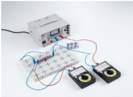
Dans l'expérience P4.1.3.3, on compare les caractéristiques de diodes électroluminescentes infrarouge, rouge, jaune et verte.
