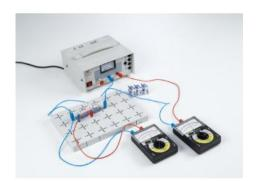
P4.1.3.3 Tracé de caractéristiques courant / tension de diodes électroluminescentes (LED)
