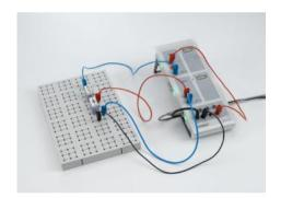
P4.1.3.5 Tracé de caractéristiques courant / tension de diodes Zener avec CASSY
