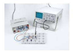
P4.1.4.1 Redressement d'une tension alternative avec des
