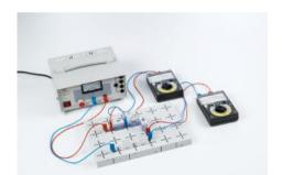
P4.1.4.2 Limite de tension à l'aide d'une diode Zener
