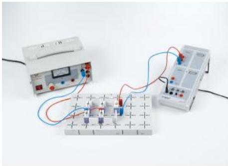
Dans l'expérience P4.1.4.4, on étudie le fonctionnement des redresseurs mono et double alternance lors du redressement d'une tension alternative : le redresseur mono alternance réalisé à partir d'une diode supprime (avec une polarisation appropriée de la diode) à chaque fois la première demi-onde de la tension alternative et n'admet qu'une demi-onde sur deux.
