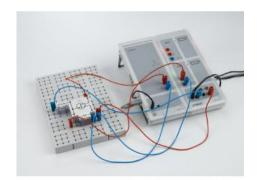
P4.1.5.5 Tracé des caractéristiques d'un transistor à effet de champ avec CASSY
