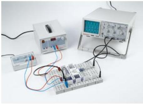
Dans l'expérience P4.1.6.1 étudie un transistor bipolaire en circuit émetteur. Le réglage du point de fonctionnement et l'amplification en fonction de la résistance démetteur sont également étudiés.
