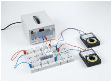
Dans l'expérience P4.1.6.6, le transistor à effet de champ fonctionne comme un interrupteur. La résistance à l'état passant est étudié à différentes tensions de polarisation ainsi que l'atténuation du signal lors de la commutation.
