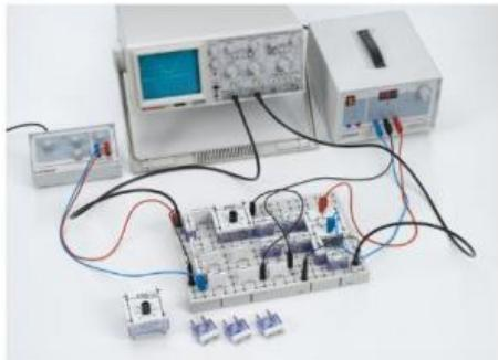
L'expérience P4.2.2.1 montre que l'amplificateur opérationnel non câblé sur module pour une différence de tension infiniment petite aux entrées.
