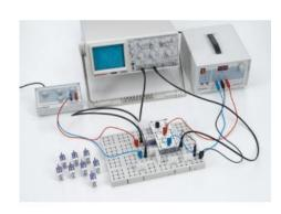
Dans les expériences P4.2.2.2 et P4.2.2.3, l'amplificateur opérationnel est relié à l'entrée inverseuse, ou non inverseuse, par une résistance R2.
