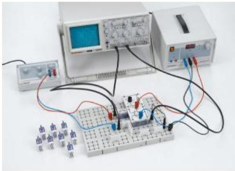
Dans les expériences P4.2.2.2 et P4.2.2.3, l'amplificateur opérationnel est relié à l'entrée inverseuse, ou non inverseuse, par une résistance R2.
