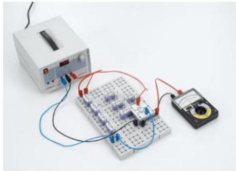
Dans l'expérience P4.2.2.4, on démontre l'addition ou la soustraction de plusieurs signaux entrée.
