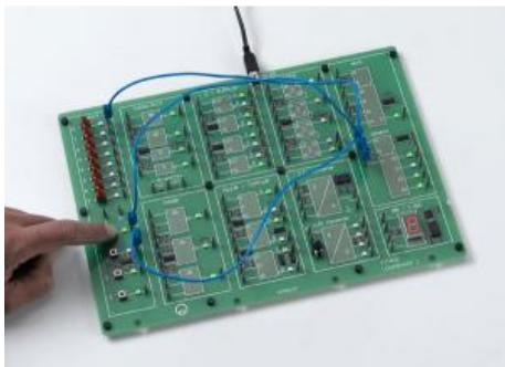
Dans l'expérience P4.5.2.3, on démontre la dérivation avec un multiplexeur de plusieurs entrées sur une sortie ainsi que la répartition avec un démultiplexeur des signaux d'une ligne d'entrée sur plusieurs lignes de sortie.
