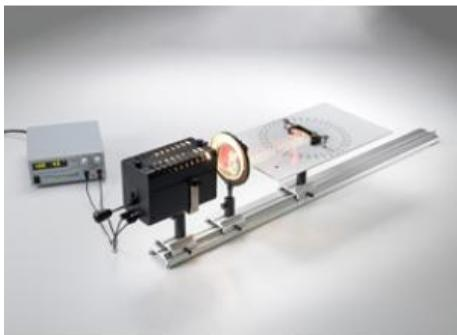
Dans l'expérience P5.1.1.1, on observe la formation de l'image réfléchie lors de la réflexion sur un miroir plan et on montre que la marche des rayons lumineux est réversible.
