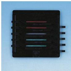
Pour la génération de faisceaux lumineux à rayons parallèles, particulièrement pour l'étude de la trajectoire des rayons avec le disque optique ( 46352 ).
