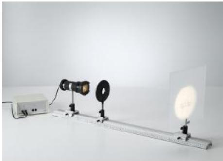
Dans l'expérience P5.1.2.4 , on mesure directement pour une lentille convergente la taille de l'objet G, la distance g séparant la source lumineuse et l'objet, la taille de l'image B et la distance b séparant l'image de l'objet et on vérifie les lois des lentilles.
