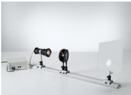
Dans les expériences P5.1.3.1 et P5.1.3.2, on considère des imperfections au niveau de la netteté de l'image. Des rayons près de l'axe ont, dans une marche de rayons lumineux parallèles à l'axe, une distance focale différente de celle des rayons qui sont loin de l'axe.
