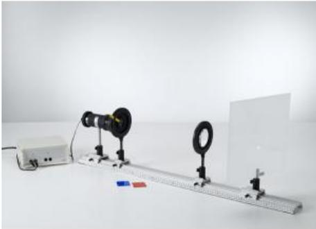
Dans l'expérience P5.1.3.4, on étudie les aberrations chromatiques. Elles résultent du changement de l'indice de réfraction avec la longueur d'onde et sont par conséquent inévitables lorsque l'on a recours à une lumière non monochromatique.
