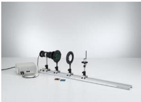
Dans l'expérience P5.2.1.1, on détermine l'angle de la déviation minimale pour un prisme en flint et un prisme en crown avec un même angle de réfraction  $\alpha$ .
