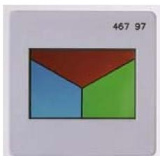
Pour les expériences sur le mélange additif des couleurs avec la lampe triple. Film-diapositive avec trois champs de différente couleur : rouge, vert et bleu ; dans cadre en plastique.
