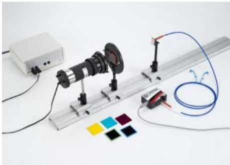
Dans l'expérience P5.2.4.3, la lumière d'une lampe traversant des verres colorés est enregistrée par un spectromètre et comparée avec un spectre continu de la lumière de la lampe.
