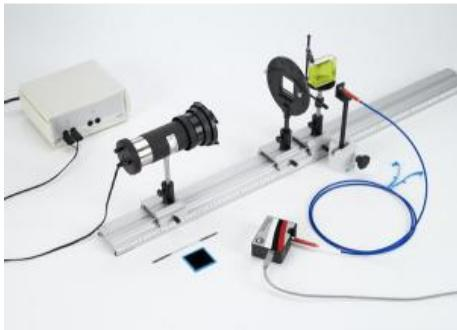
Dans l'expérience P5.2.4.4, la lumière d'une lampe traversant des liquides colorés est enregistrée par un spectromètre et comparée avec un spectre continu de la lumière de la lampe.
