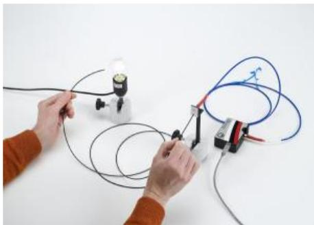
Dans l'expérience P5.2.4.5, on étudie la transmission optique de la fibre conductrice de lumière. Les sons harmoniques des oscillations moléculaires conduisent à des plages spectrales où la fibre est transparente et à d'autres où elle absorbe fortement ("fenêtre optique"). Ces sons harmoniques sont enregistrés et évalués à l'aide d'un spectromètre compact.
