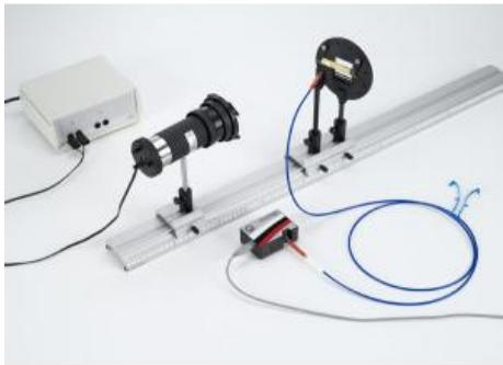
Dans l'expérience P5.2.5.1, la réflexion sur différents matériaux de la lumière d'une lampe à incandescence est enregistrée à l'aide d'un spectromètre.
