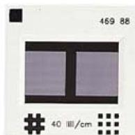
Réseau et réseau inverse, réalisés par technique photographique, dans cadre de diapositive
