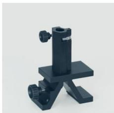
Cavalier pour banc d'optique à profil normalisé.
