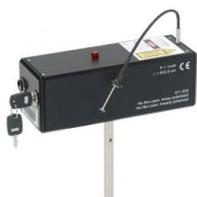
Source de lumière idéale pour tous les dispositifs expérimentaux pour lesquels un faisceau de lumière intensif à rayons parallèles est nécessaire (par ex. diffraction, interférence, holographie).
