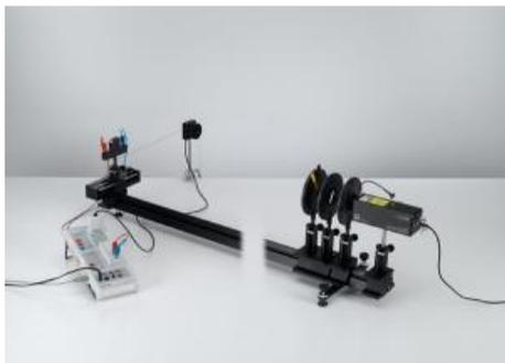
Dans l'expérience P5.3.1.4, on étudie la diffraction par une fente de largeur variable. Les valeurs mesurées enregistrées pour l'intensité  $I$  sont comparées avec le résultat d'un modèle de calcul réalisé pour de petits angles de diffraction dans lequel la largeur de fente  $b$  est retenue comme paramètre :
