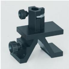
Cavalier pour banc d'optique à profil normalisé.
