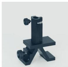
Cavalier pour banc d'optique à profil normalisé.
