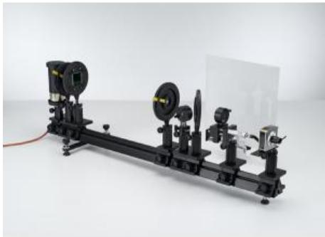
Dans l'expérience P5.3.4.5 on détermine les longueurs de cohérence et les largeurs spectrales de la raie spectrale verte d'une lampe au mercure et d'une lampe à vapeur de mercure pour comparer les résultats.
