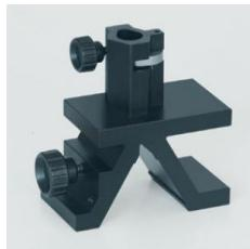
Cavalier pour banc d'optique à profil normalisé.
