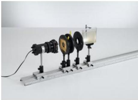
Dans l'expérience P5.4.1.3, on met en évidence le fait que la lumière non polarisée devient par diffusion dans une émulsion, par exemple du lait dilué, et que de la lumière polarisée n'est pas diffusée uniformément dans toutes les directions.
