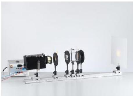
Dans l'expérience P5.4.3.3, on monte un polarimètre à pénombre à partir d'éléments discrets: un polariseur et un analyseur entre lesquels on place la substance optiquement active.
